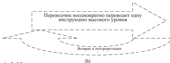
Рисунок 1.8 Компиляция в сравнении с интерпретацией. (a) схематическая компиляция (b) схематическая интерпретация.
