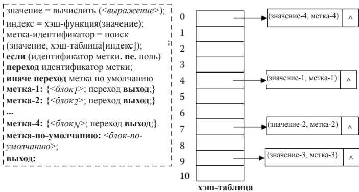
РИСУНОК 5.3 Перевод оператора варианта с помощью хэш-таблицы.
