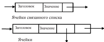
РИСУНОК 6.2 Распределение ячеек в блоках связанных списков и деревьев.
