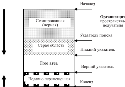
Рисунок 6.12 Пространство-получатель во время инкрементного копирующего сбора мусора.
