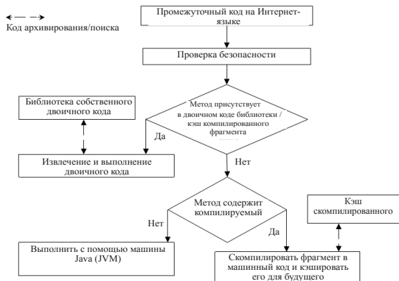
Рисунок 1.9 Схематичная JIT компиляция.
