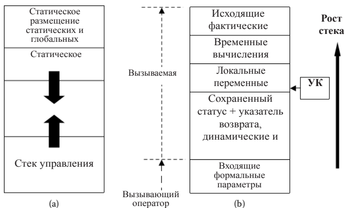
РИСУНОК 5.8 Область данных для блочно-структурированного языка. (a) - Общая область данных, (b) - кадр.
